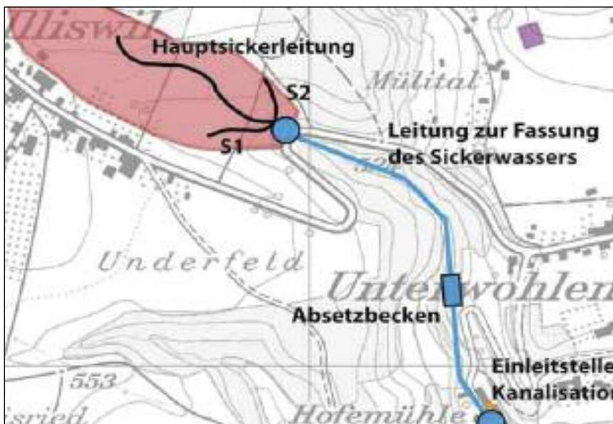
Hauptsickerleitung mit den beiden Nebensickerleitungen S1 und S2.
